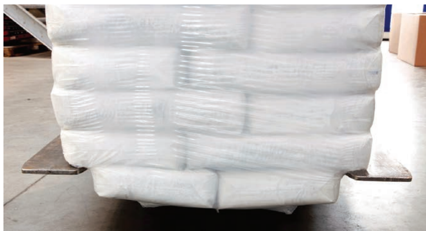
Palletless: solução da Beumer monta a carga sem a necessidade de palete
