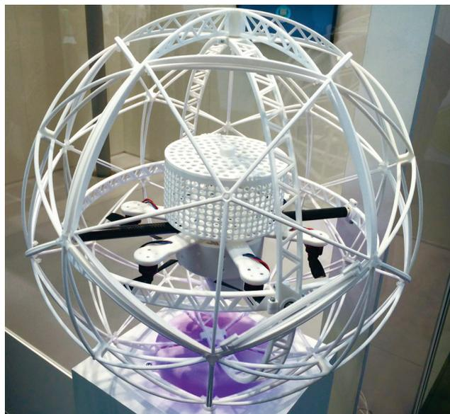
Uma das maiores inovações da CeMAT ficou por conta dos drones que voam dentro dos armazéns retirando as caixas nas prateleiras e levando-as até o check-out. Envolta por uma esfera, a solução promete revolucionar os armazéns.
