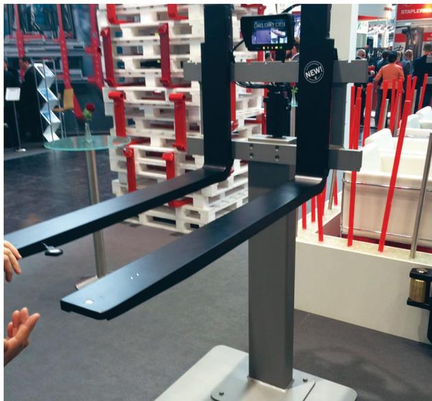
A Vetter apresentou um garfo inteligente com cinco funcionalidades, incluindo iluminação para evitar acidentes, laser para ajustar rapidamente ao nível da estrutura e câmara frontal para visualizar operação nas alturas.
