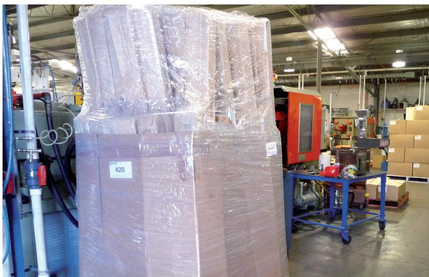
*Shrinksheet: o filme é aquecido e encolhe para envolver a carga*
