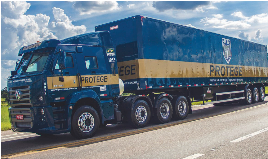
Caminhão Titanis: cavalo mecânico e o semirreboque são blindados
