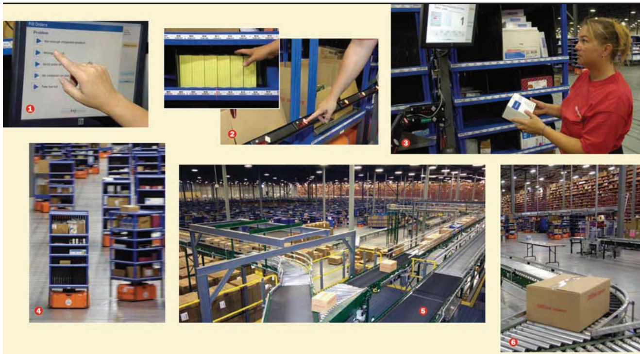
1. As instruções de separação são distribuídas em uma tela sensível ao toque. 2. Os funcionários separam os itens. 3. Os itens separados são colocados em uma estanteria (módulo portátil). 4. Os robôs móveis levam os módulos até o sistema de transportadores contínuos (5) para indução. 6. As caixas são classificadas para uma estação de embalagem.
