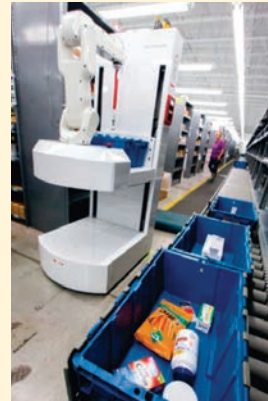
A Cooperativa de Medicamentos de Rochester (RDC) está provando que a separação por robôs móveis pode ser viável. Em uma área de 1.900 m 2 de um CD em Nova Iorque, os robôs percorrem zonas, escolhendo SKUs de movimentação lenta
