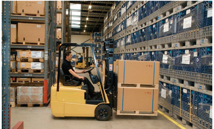
Empilhadeiras de 3 rodas possuem menor raio de giro o que possibilita operação em corredores mais estreitos
