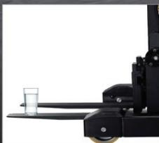
RRE-H é a escolha certa para operações que exigem alto desempenho, sem comprometer a segurança do operador e a integridade da carga com exclusivo e patenteado sistema TLC (Transitional Lift Control), que permite elevar e descer os garfos suavemente, sem vibração e choque, mesmo na velocidade máxima, o que garante manter a integridade da carga.
